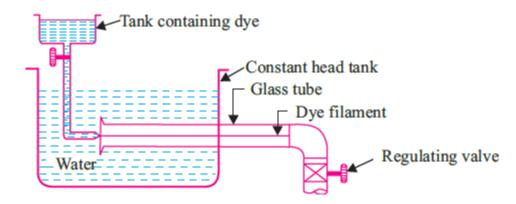
Fig.10.1. Reynolds apparatus.
